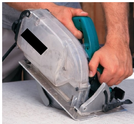
Figura 3 - Sega circolare con depolverizzatore
