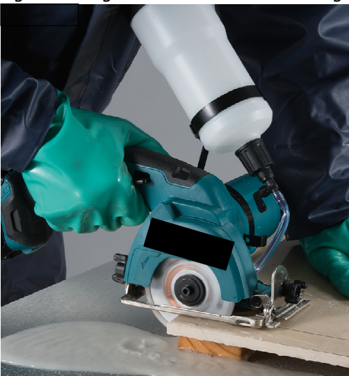
Figura 7 - Sega a disco con sistema di bagnatura
